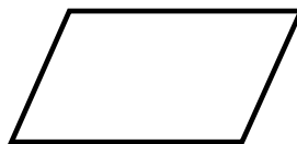
ภาพที่ 2.7 แสดงสัญลักษณ์การนำเข้าข้อมูลเข้า (INPUT) หรือการนำข้อมูลออก (OUTPUT)
