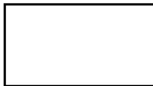
ภาพที่ 2.4 แสดงสัญลักษณ์การกำหนดค่า (Assignment)
